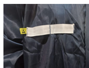
Tira de aterramento lado direito (porta crachá)
