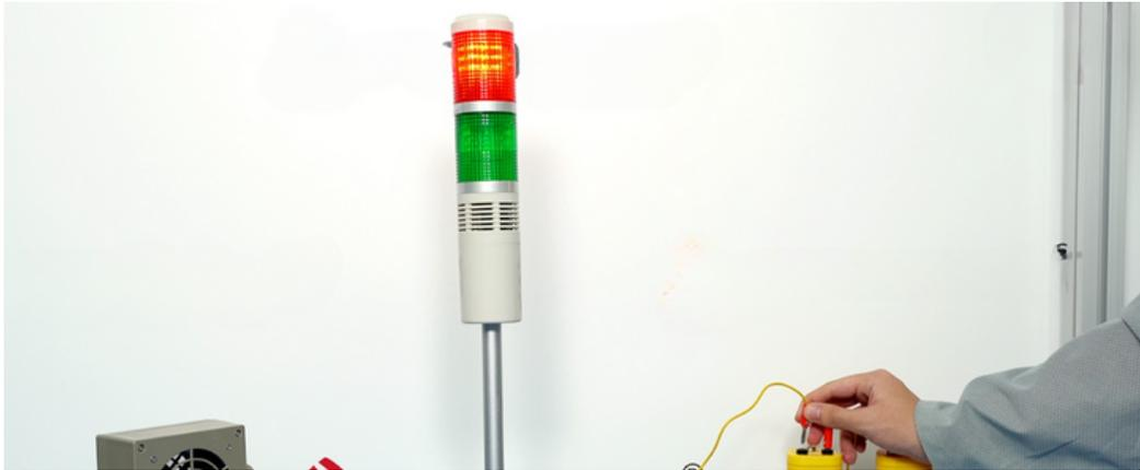
O indicador LED externo ficará vermelho com alarme quando o fio de aterramento do equipamento monitorado ou o fio de aterramento principal é anormal
