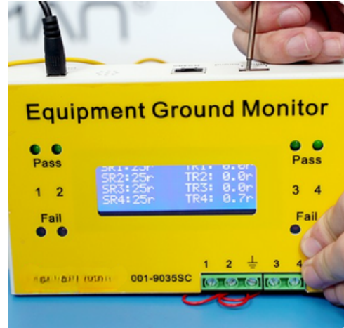
Dip switch a pode ajustar limites específicos de resistência de acordo com as exigências do cliente
