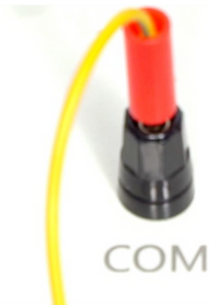
Conecte o fio de aterramento principal à porta COM na caixa de resistência
