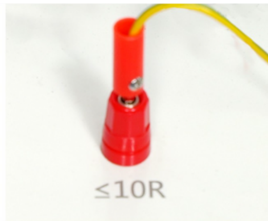
conecte o fio de aterramento pendente para testar a << porta 10R na caixa de resistência
